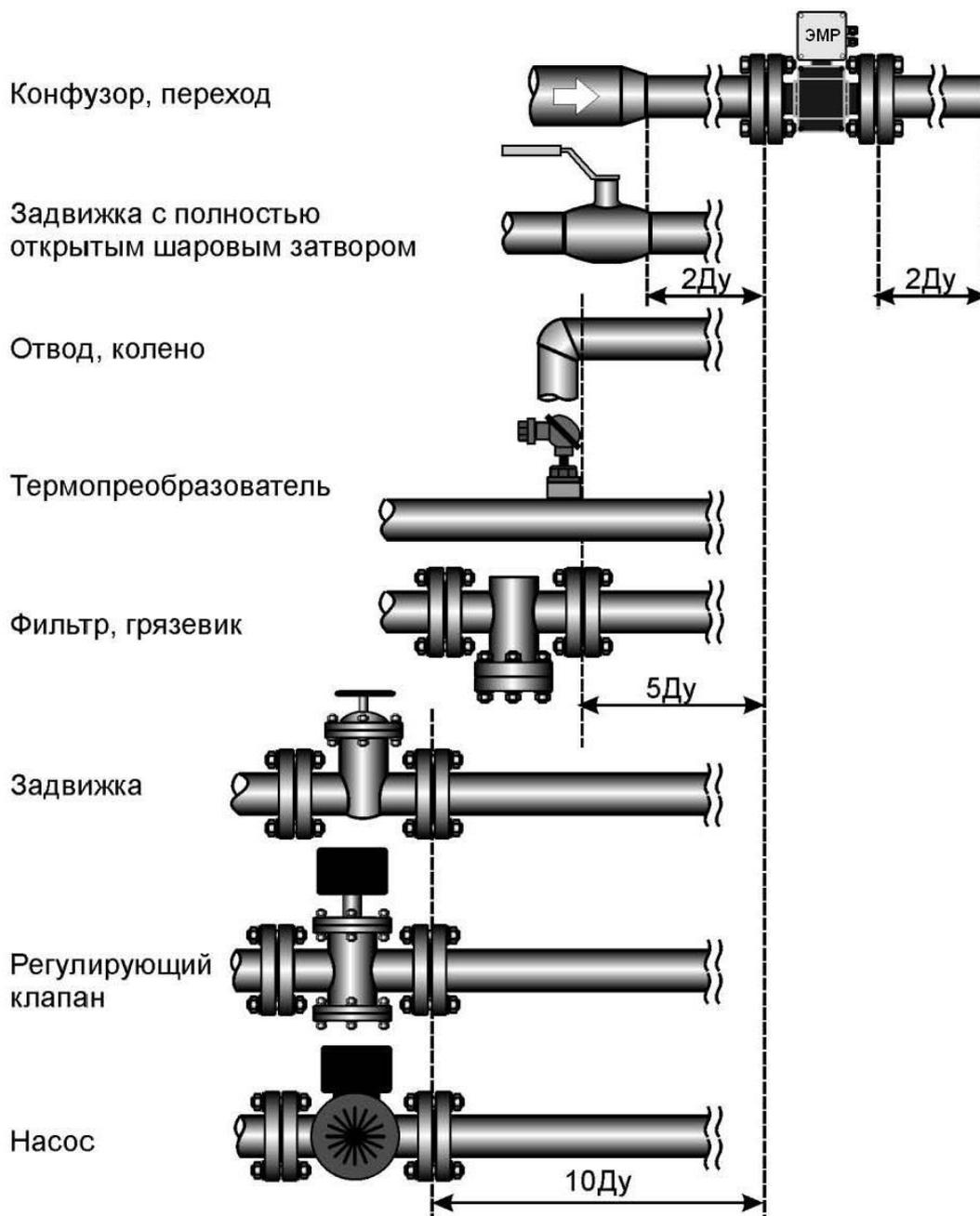
**Прямой участок** – прямолинейный отрезок трубопровода, не содержащий местных гидравлических сопротивлений (сужения, расширения, задвижки, клапаны, термопреобразователи и др.).
