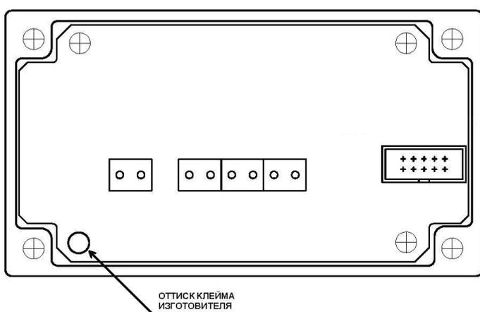
Рисунок 4.3 – Места пломбирования
