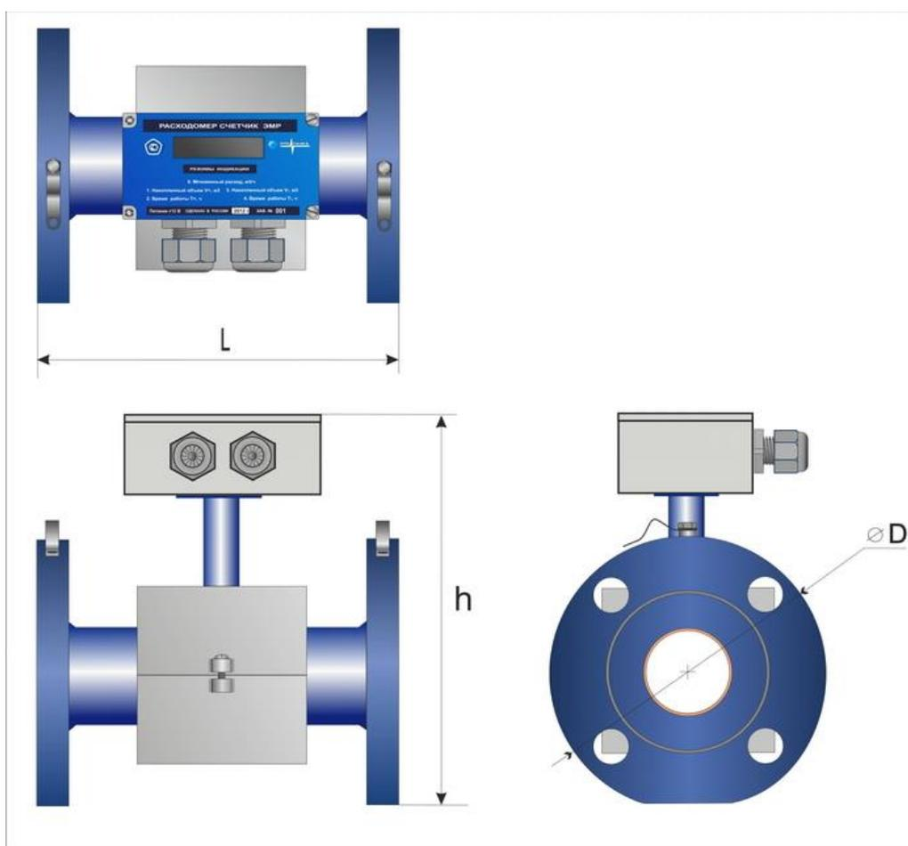
Рисунок 2.1 - Габаритные и установочные размеры расходомеров.
