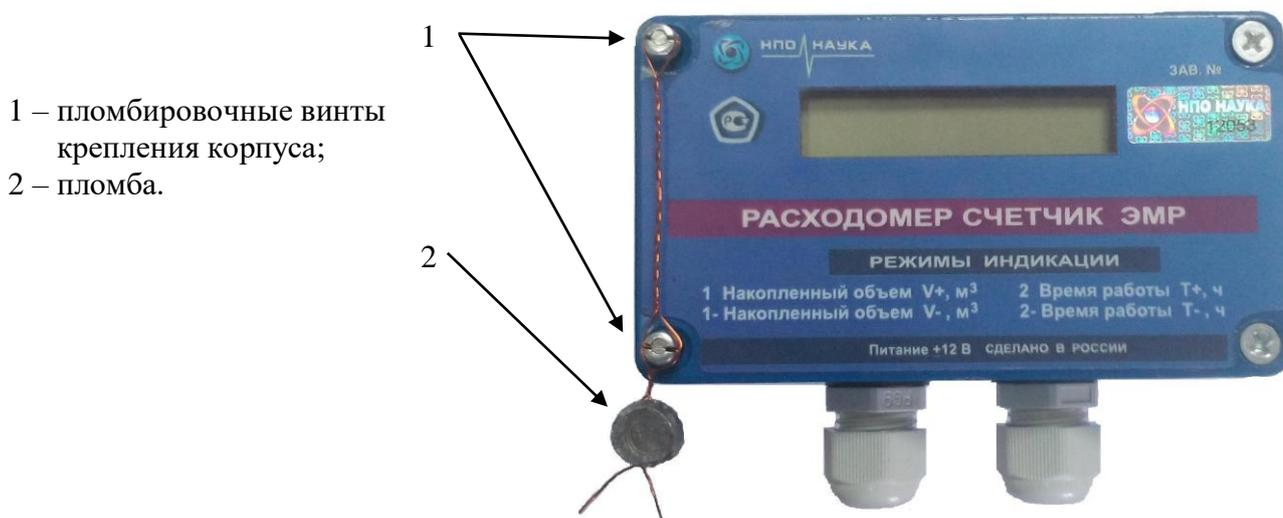
Рисунок 4.4 - Схема пломбировки расходомеров
